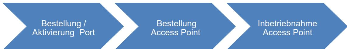
Zuerst wird der notwendige Port gemäss Kapitel 4.1.2 bestellt bzw. aktiviert. Sobald die Aktivierung abgeschlossen und die Kabel gepatcht sind, kann die nächste Bestellung durchgeführt werden.
