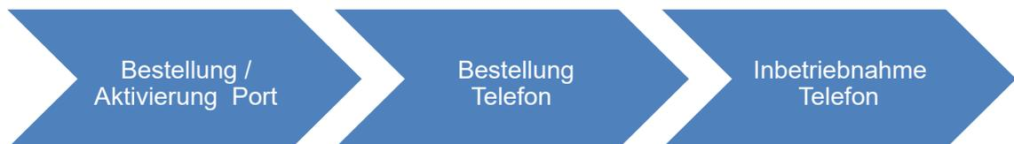
Zuerst wird der notwendige Port gemäss Kapitel 4.1.2 bestellt bzw. aktiviert. Sobald die Aktivierung abgeschlossen und die Kabel gepatcht sind, kann die nächste Bestellung durchgeführt werden. Dies gilt ebenfalls bei einem Umzug eines Telefonapparats.
